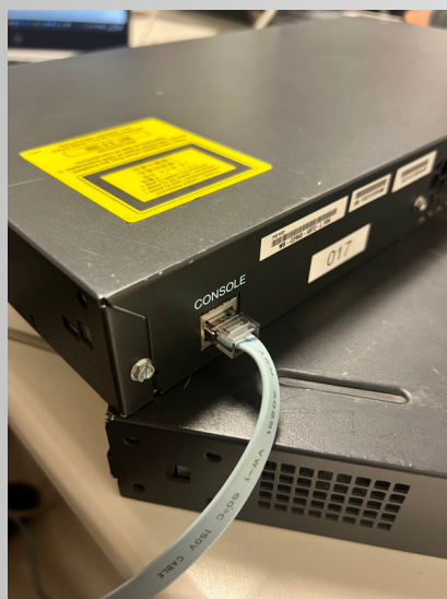
Branchement du câble console du routeur au PC
